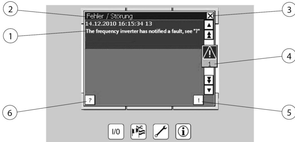
274. ábra: Frekvenciaváltó hibaüzenet
