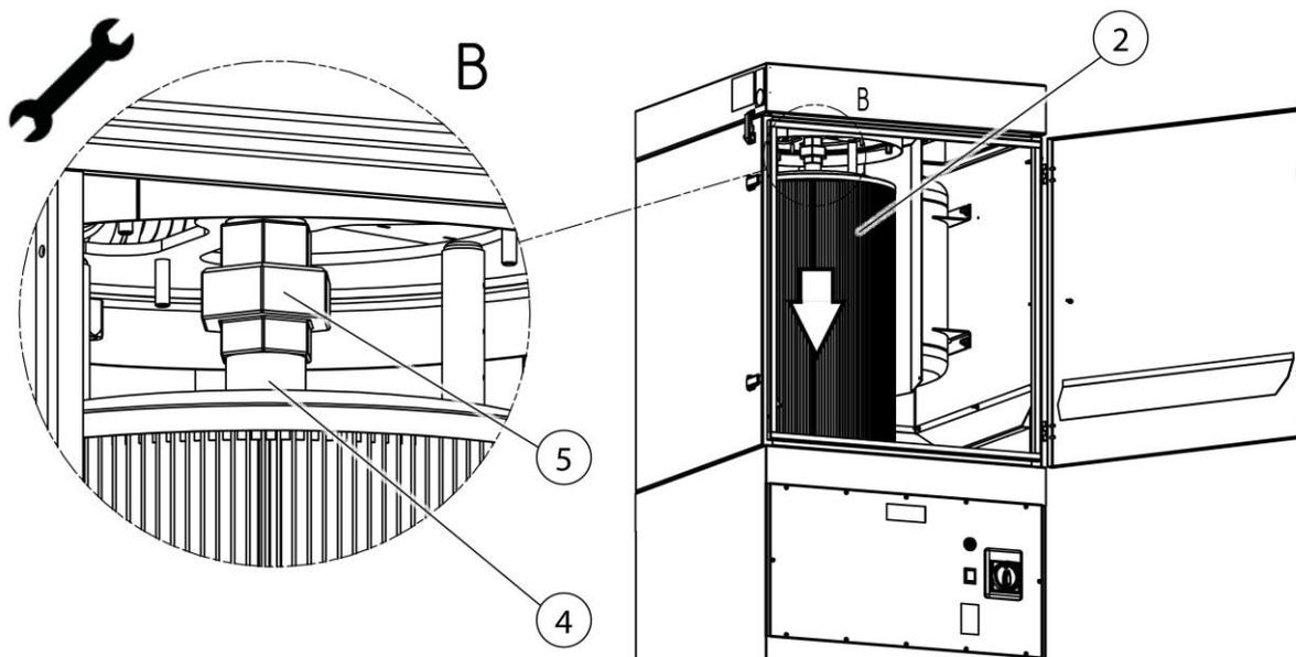
Abb. 9: Filterpatrone entnehmen
