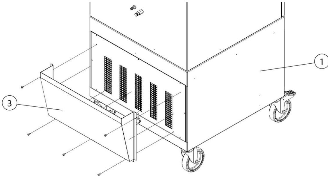
Abb. 3: Montage Ausblasgehäuse
