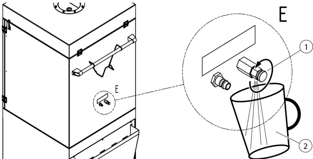
Abb. 7: Kondensat ablassen
