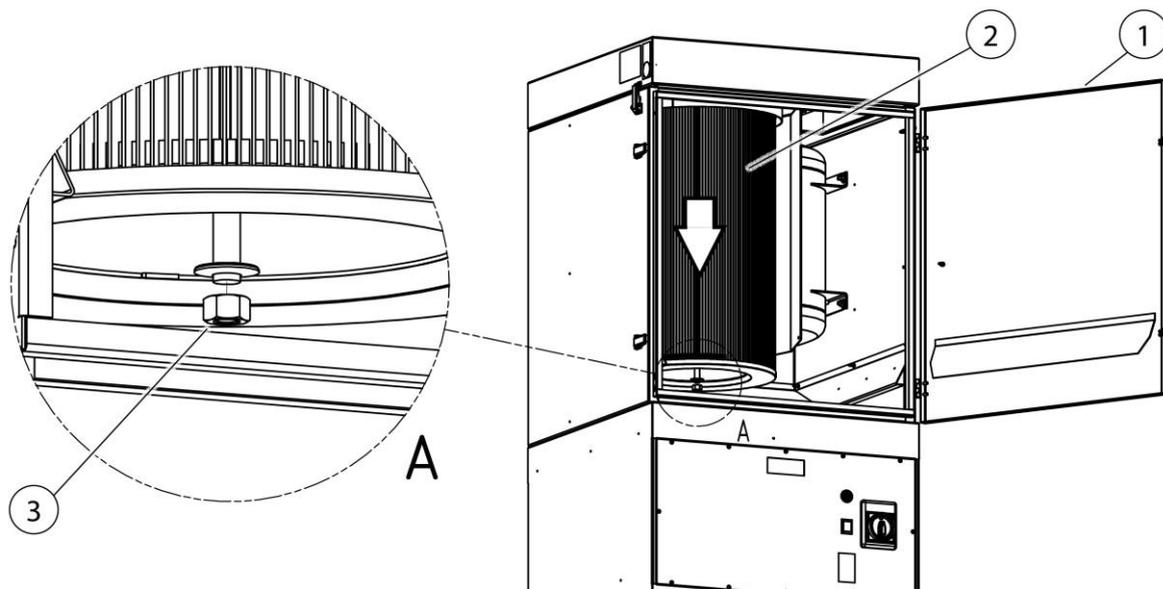
Abb. 8: Filterwechsel
