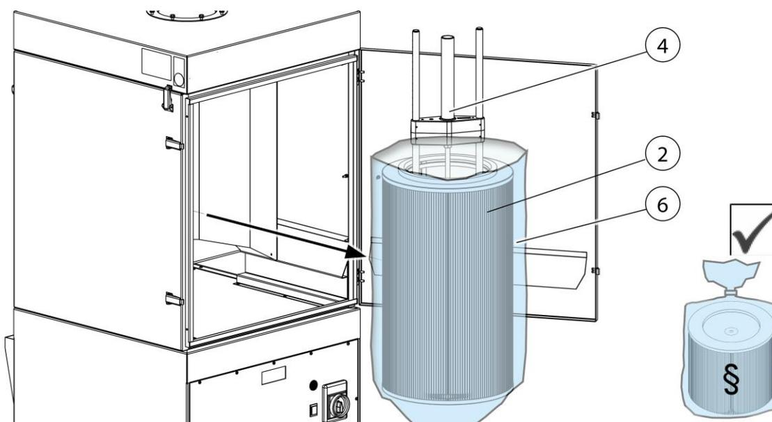
Abb. 10: Filterpatrone Entnehmen
