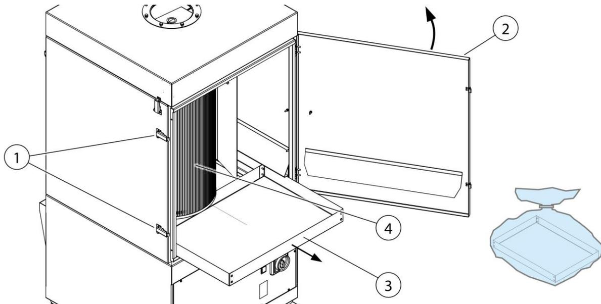
Abb. 6: Entleeren des Staubsammelbehälters
