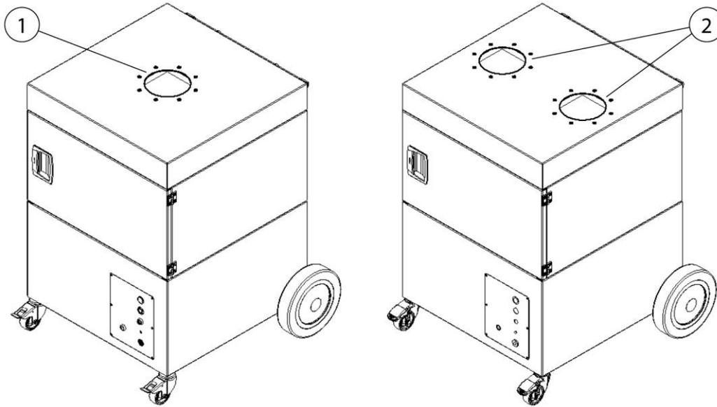
Abb. 3: Unterscheidungsmerkmale 1/2 Absaugarme
