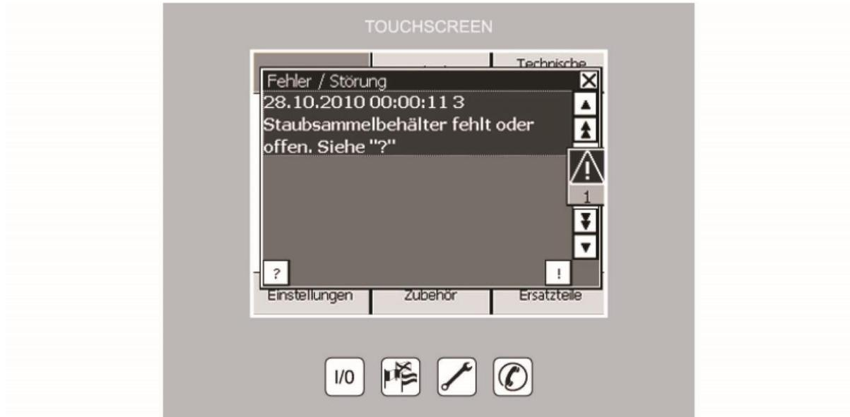
Abb. 56: Störungsmeldung Staubsaammelbehälter
