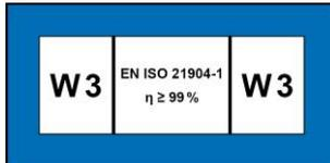
Ist das Produkt mit dem W3-Aufkleber versehen, hat das Produkt die IFA-Zulassung und ist nach Anforderungen der Schweißrauchabscheideklasse W3-geprüft.
