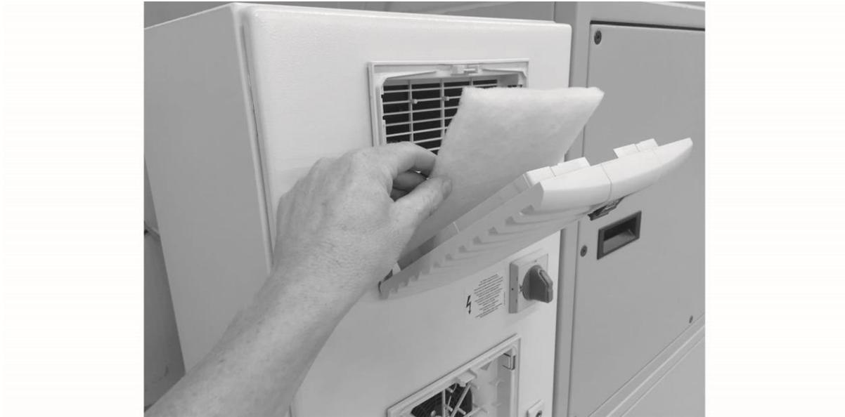
*Fig. 57: Cambio del filtro del armario de distribución*
