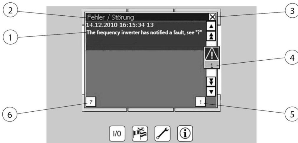
Fig 52: Mensaje de error convertidor de frecuencia
