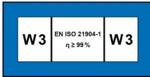
Ist das Produkt mit dem W3-Aufkleber versehen, hat das Produkt die IFA-Zulassung und ist nach Anforderungen der Schweißrauchabscheideklasse W3-geprüft.
