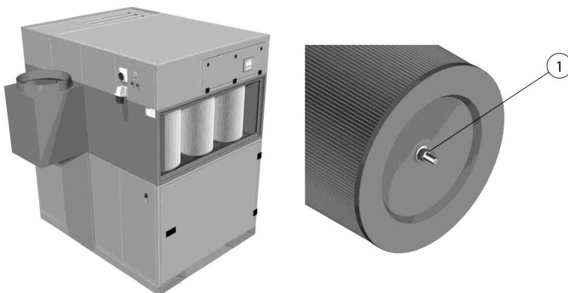
Sl. 349: Menjava filtra – pokrov za vzdrževanje
