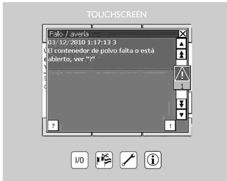
Fig. 158: Mensaje de fallo del depósito colector de polvo
