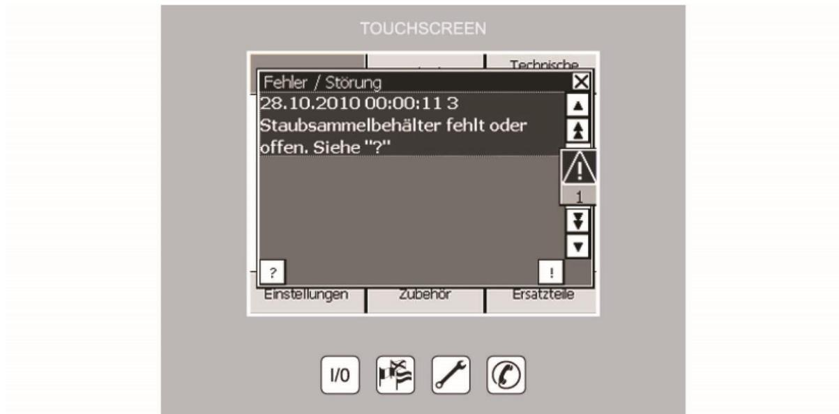
Abb. 38: Störungsmeldung Staubsaammelbehälter
