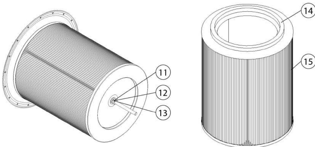
Rys. 43: Widok wkładu nabojowego
