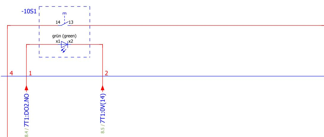
Anschlußbuchse Start-Stopp Sensor
