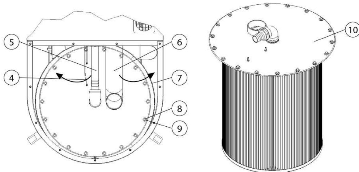
Obr. 19: Výměna hlavního filtru - uchycení filtru
