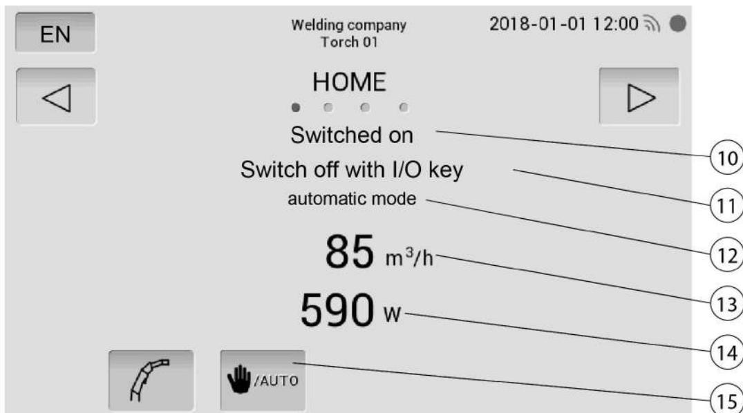
Obr. 6: Bod nabídky - ÚVOD - Automatický režim
