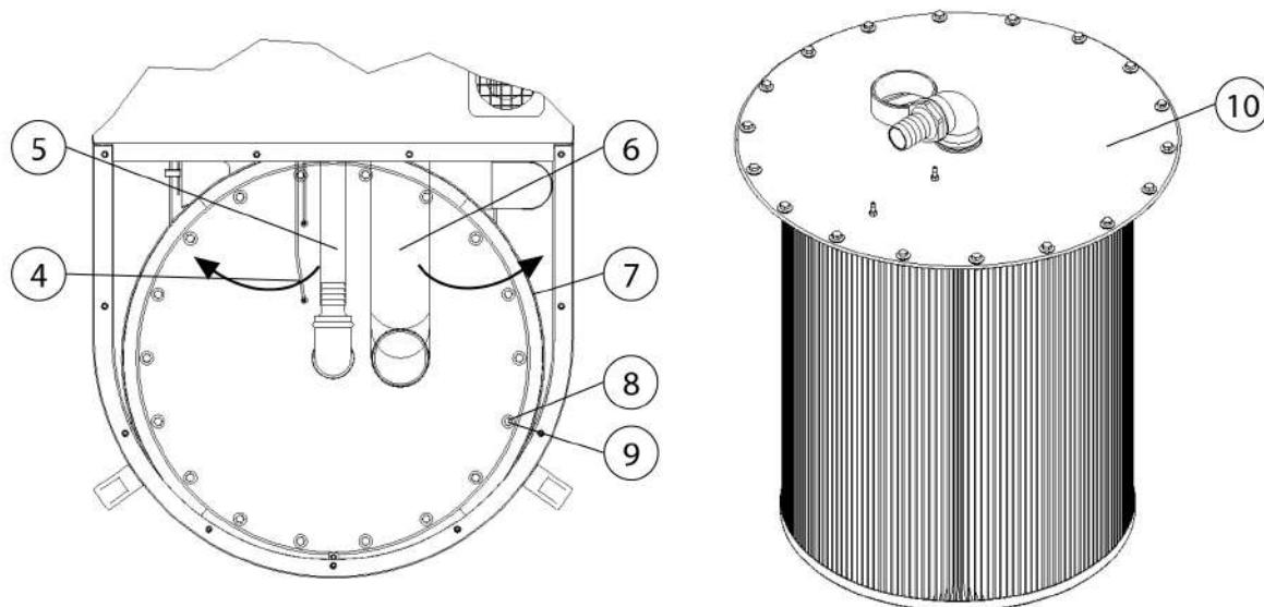
Rys. 41: Wymiana filtra głównego – uchwyt filtru
