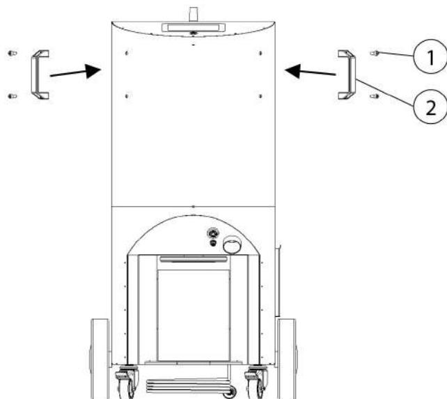
Obr. 2: Montáž rukojetí
