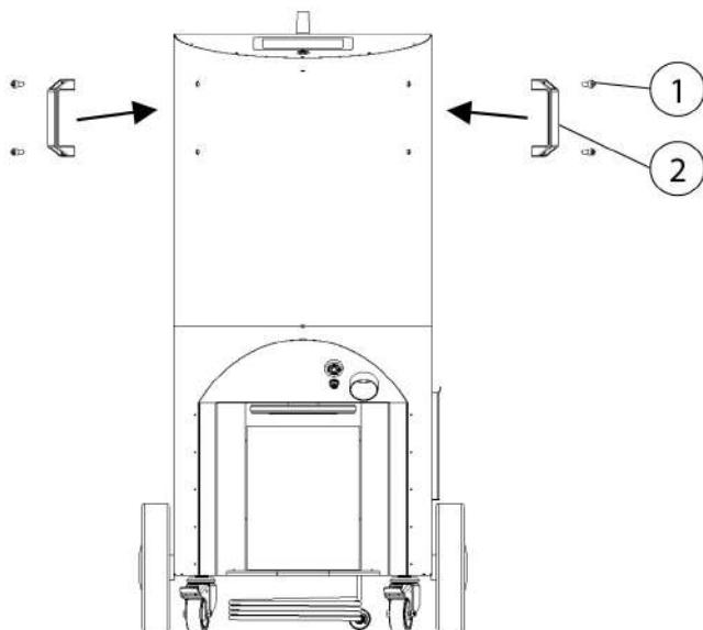
Рис. 4б: Монтаж рукояток
