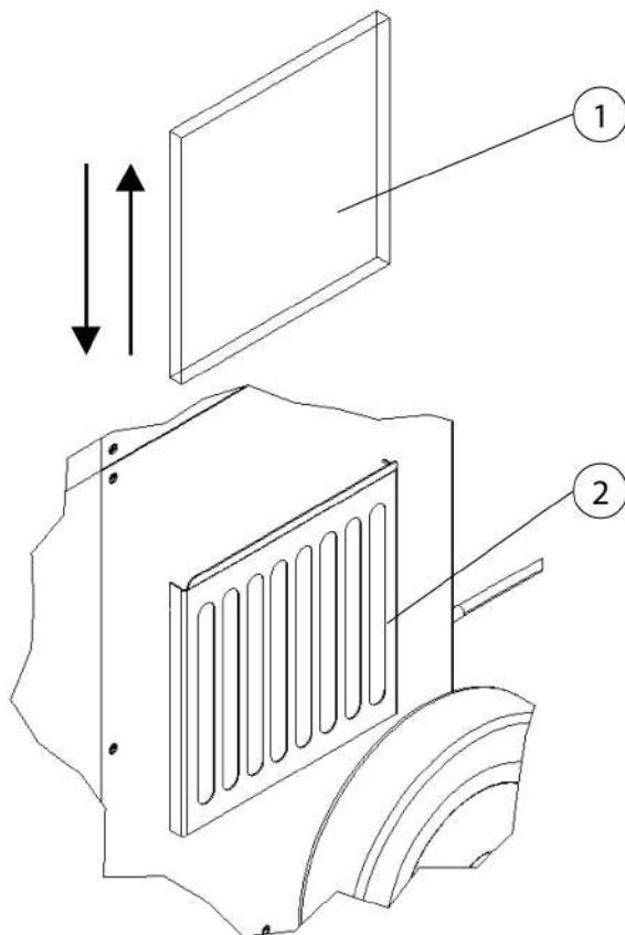
*Рис. 61: Замена матта фильтра предварительной очистки*
