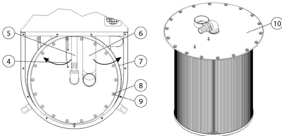
Рис. 63: Замена главного фильтра - корпус фильтра
