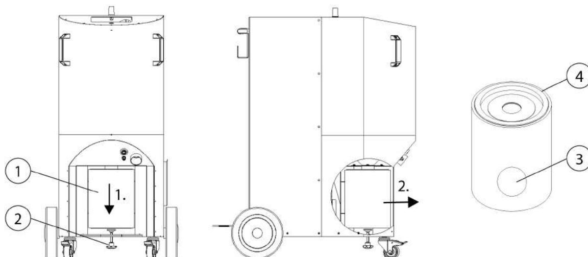
Obr. 14: Výměna sběrné prachové nádoby
