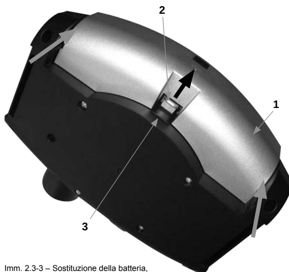
Imm. 2.3-3 – Sostituzione della batteria, vista dal retro senza tracolla
