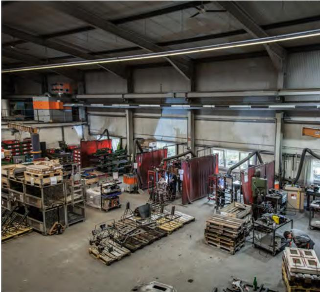
Si bien la empresa alemana Tenwinkel GmbH & Co. KG ya contaba con sistemas de aspiración puntual, el endurecimiento de las restricciones en el lugar de trabajo puso la protección laboral en la producción de nuevo en el punto de mira. La empresa dejó de centrarse en los puestos de trabajo de forma individual y dirigió la mirada a la calidad del aire en toda la nave.
