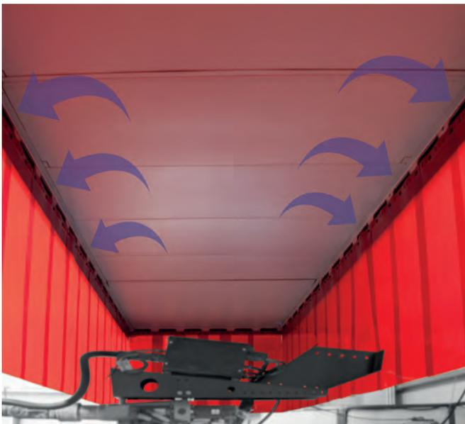
La campana de extracción modular VarioHood puede configurarse individualmente con dimensiones por segmentos de 450 mm x 450 mm hasta un ancho máximo de 3.150 mm. La longitud no es importante. KEMPER ya ha puesto en marcha campanas de extracción con una longitud de más de 20 metros. Gracias a la construcción enchufable, la instalación es un muy sencillo y los costos de transporte son bajos.
