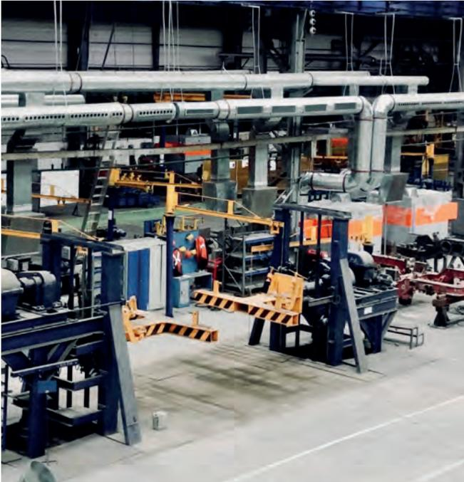
Ya sea un sistema de ventilación de desplazamiento o mixto: La ventilación ambiental para los humos de la soldadura es más que un complemento para la extracción localizada. También garantiza la seguridad laboral de los puestos de trabajo circundantes.
